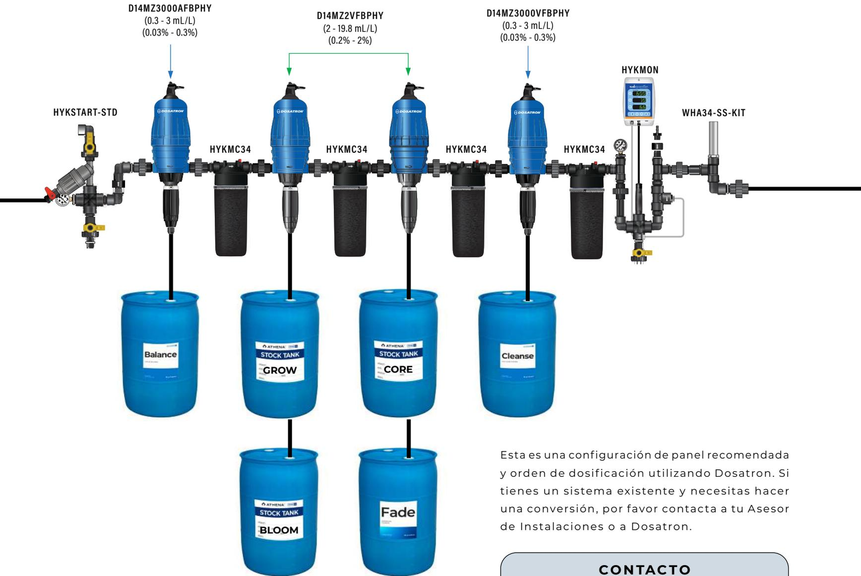
Esta es una configuración de panel recomendada y orden de dosificación utilizando Dosatron. Si tienes un sistema existente y necesitas hacer una conversión, por favor contacta a tu Asesor de Instalaciones o a Dosatron.
