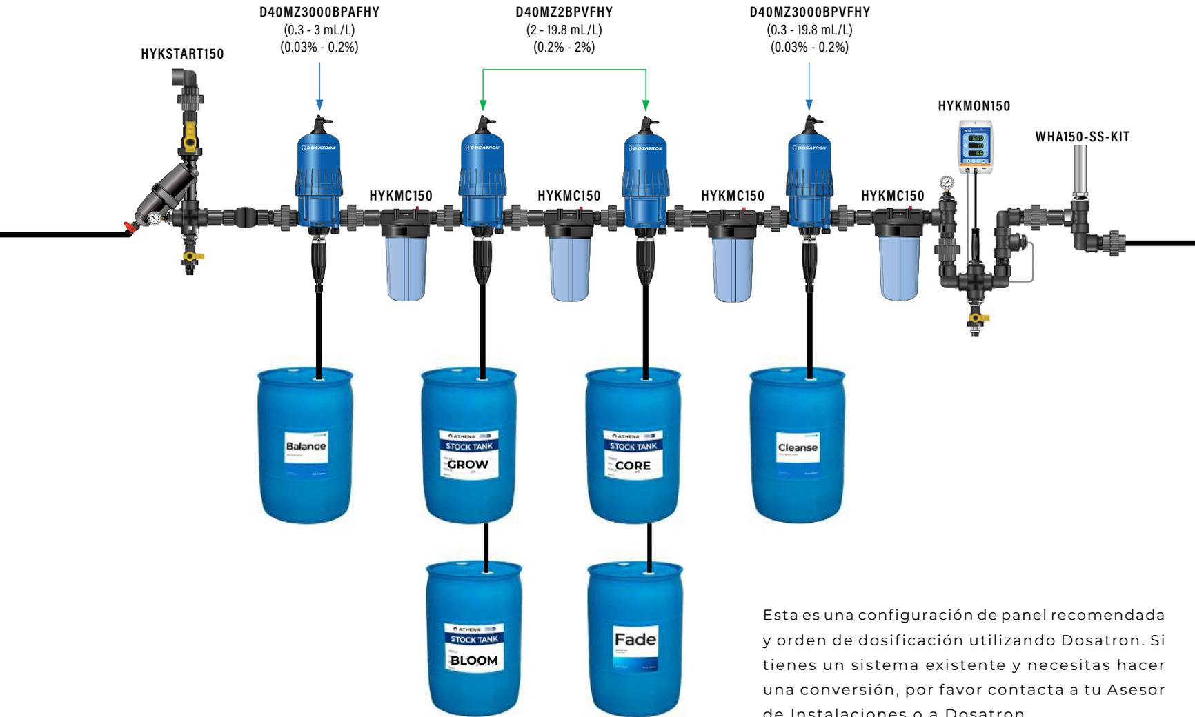
Esta es una configuración de panel recomendada y orden de dosificación utilizando Dosatron. Si tienes un sistema existente y necesitas hacer una conversión, por favor contacta a tu Asesor de Instalaciones o a Dosatron.
