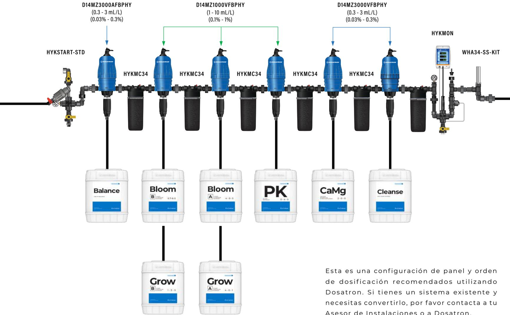
Esta es una configuración de panel y orden de dosificación recomendados utilizando Dosatron. Si tienes un sistema existente y necesitas convertirlo, por favor contacta a tu Asesor de Instalaciones o a Dosatron.
