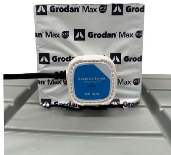
En caso de que se utilicen macetas plásticas, recomendamos realizar una abertura lo suficientemente grande, de manera que las puntas del sensor tengan contacto únicamente con el medio de cultivo y no con la maceta.
