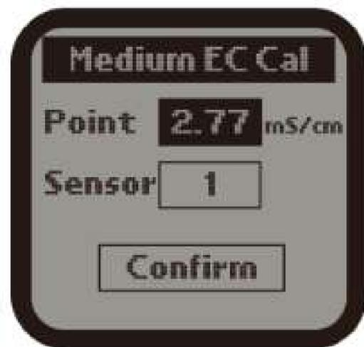
En la controladora tienes que ir al menú de calibración y setear en nivel de EC que se está utilizando en la solución.
