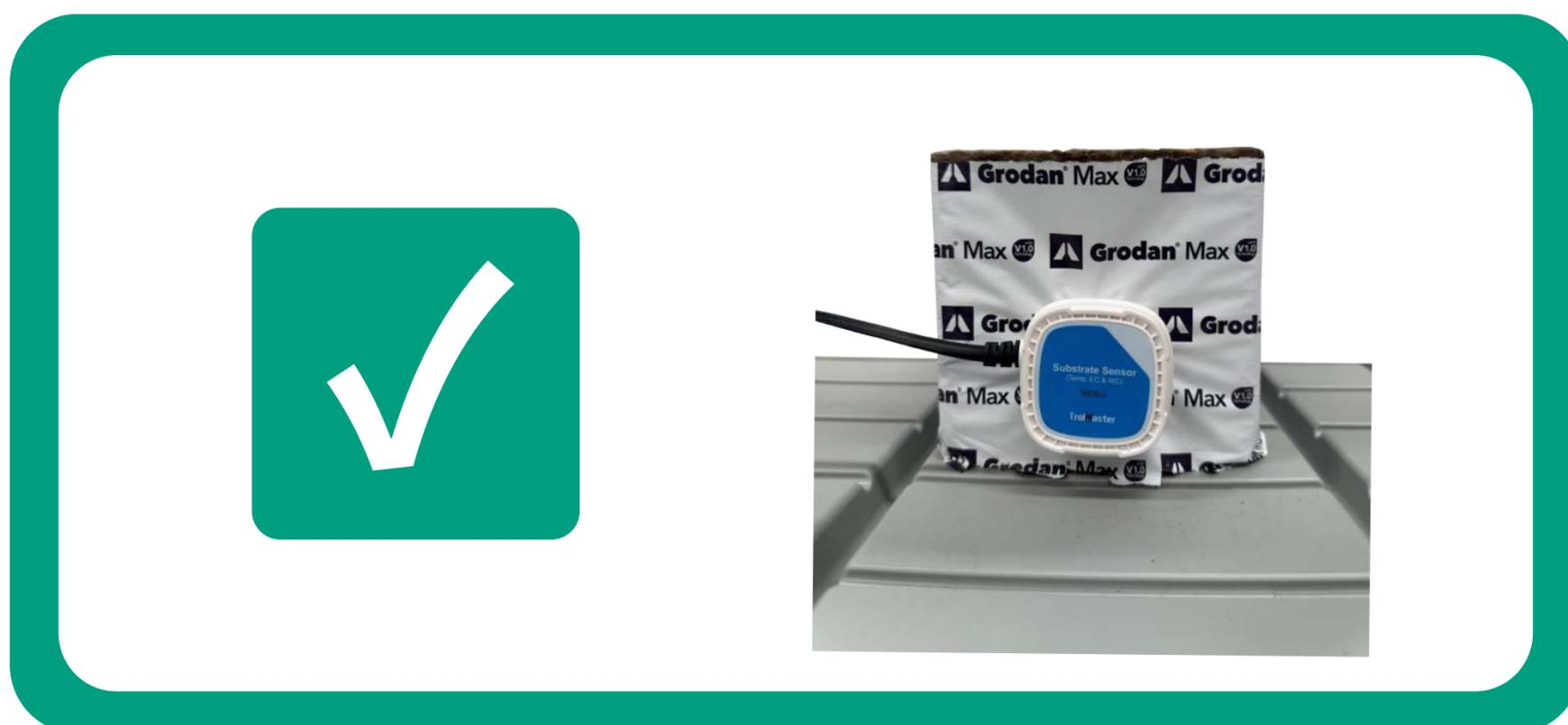
Es importante conectar el sensor horizontalmente, para que cada punta quede a diferente altura así poder obtener una medida promedio precisa.
